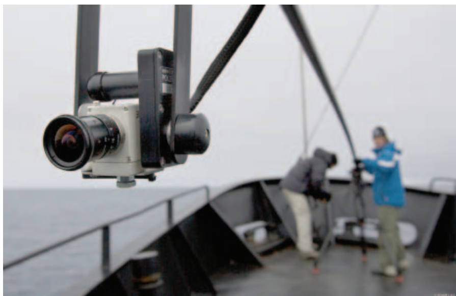
POV-камера Toshiba, закрепленная на стреле крана
